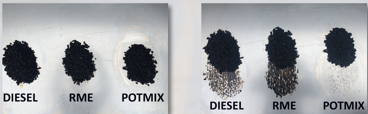
TEST 2: Upplösning av varmasfalt efter fyra timmar
